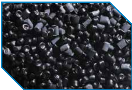
Technologie PSA využívá uhlíkové molekulární síto - navržené pro více než 10letou provozní životnost.
